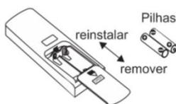
**Nota:** Quando efetuar a troca de pilhas, não coloque de modelos diferentes do descrito e não utilize pilhas velhas, pois isto pode danificar o controle remoto. Não deixe o controle remoto perto de aparelhos eletrônicos, o controle pode não funcionar corretamente.
