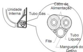
fixação. Ao prendê-los em um determinado nível, separe a alimentação interna e, então, separe a mangueira de drenagem.
