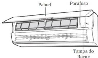
3. Remova o grampo de cabo, conecte o cabo de conexão de energia no terminal de fiação de acordo com a cor, aperte o parafuso e, em seguida, fixe o cabo de conexão de energia com o grampo de cabo.
