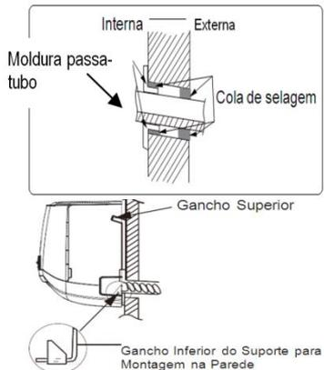
**Nota:** Não dobre a mangueira de drenagem excessivamente para evitar bloqueio.
