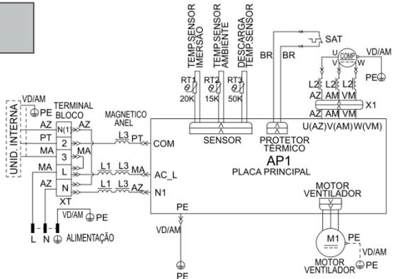
**Esquema Elétrico Externo (Quente/Frio):**
