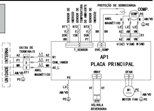
**Esquema Elétrico Externo (Quente/Frio):**
