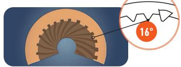
A textura mais fina (16°) aumenta a superfície de contato entre o fluido refrigerante e a parede do tubo em 10%.
