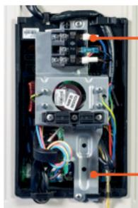
**Placas eletrônicas recebem tripla camada de resina anticorrosão**, protegendo contra umidade, poeira, insetos e curtos-circuitos. Também possuem proteção contra variações de tensão.
